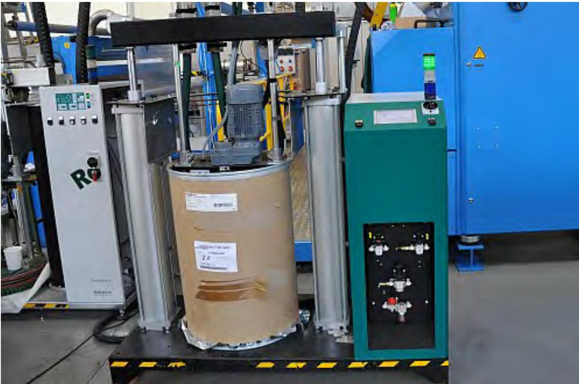
Im Einsatz zeigt sich die verbesserte Schmelzleistung deutlich. Der RobaDrum 200 meistert die ihm gestellte Aufgabe überzeugend. Er erfüllt die Anforderungen und trägt zur Effizienzsteigerung des Produktionsprozesses bei. Trotz des hohen Klebstoffdurchflusses bleibt der Förderdruck durch die gesteigerte Pumpen - leistung konstant.
