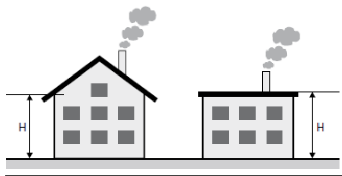
Abb. 3 Kaminhöhenbestimmung für Holzfeuerungen grösser 70 kW (BAFU, 2013)
