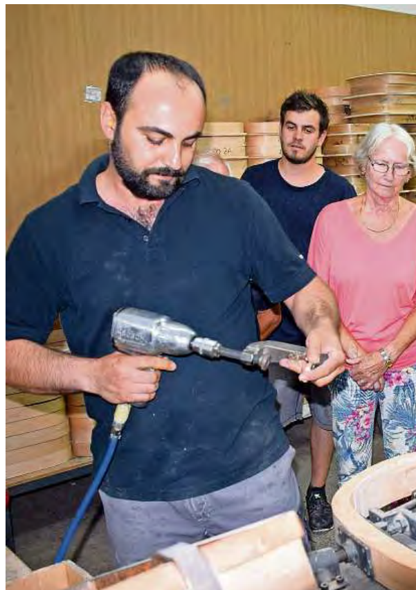
Sitzfläche entsteht: Das gebogene Holz wird zusammengeleimt.
