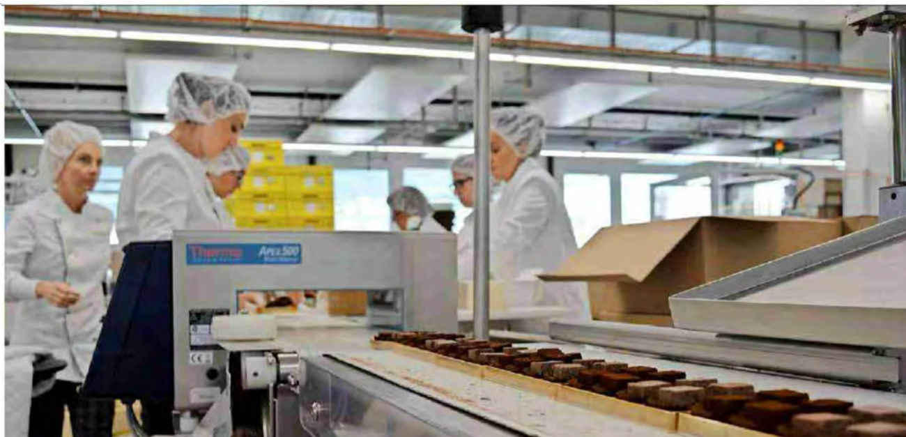
Qualitätskontrolle bei Pralinés: Im neuen Läderach-Gebäude werden die Pralinés durch einen Metalldetektor geschickt, bevor sie verpackt werden.
