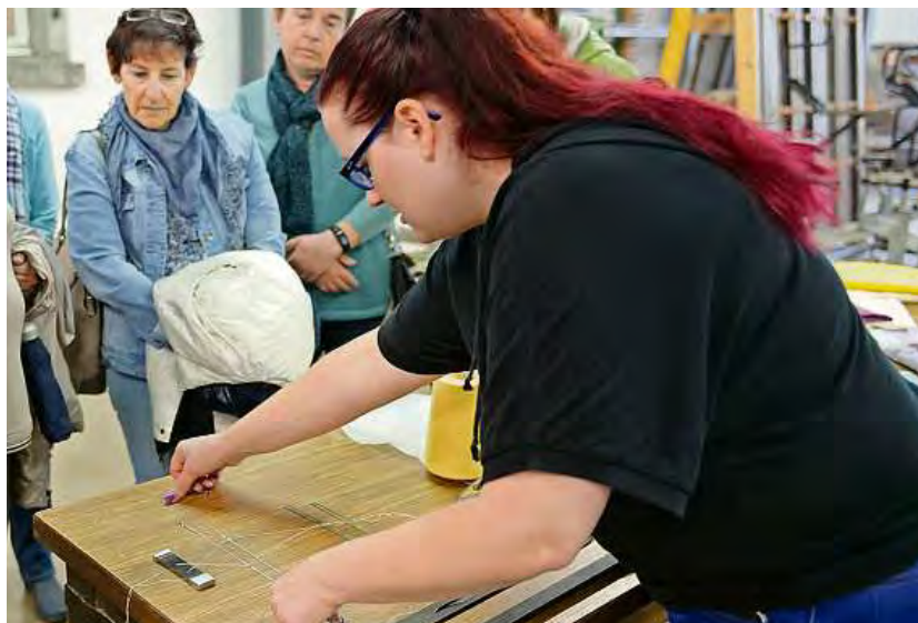
Das Prinzip: Cécile Horath erklärt, wie Kettfäden und Schussfäden zum Gewebe verkreuzt werden.
