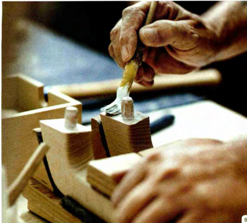
8: Die Stuhlelemente werden noch mit Leim verklebt.
