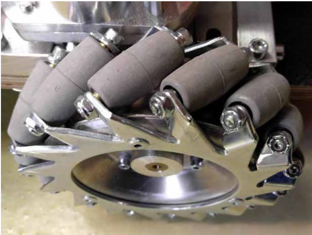
Walzen statt Reifen: Mit seinen Mecanum-Rädern kann der Roboter in alle Richtungen fahren, ohne sich zu
