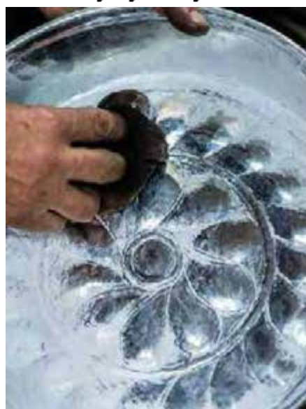
Ein Wisch mit dem Lappen, und die Verzinnung beginnt zu glänzen.
