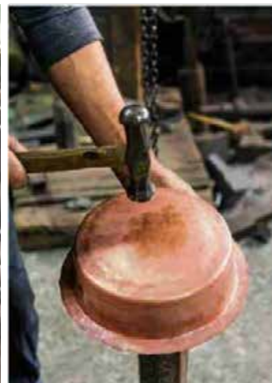
Auf dem Amboss schlägt der Schmied das Metall.
