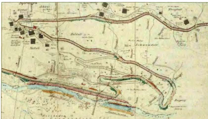
Die Spiringer Kehren der Schächental- und Klausenstrasse: 20 Jahre nach ihrem Bau wurde die aufwendige Konstruktion vollständig erneuert, ein weiteres Mal in den Jahren 1992/93.
