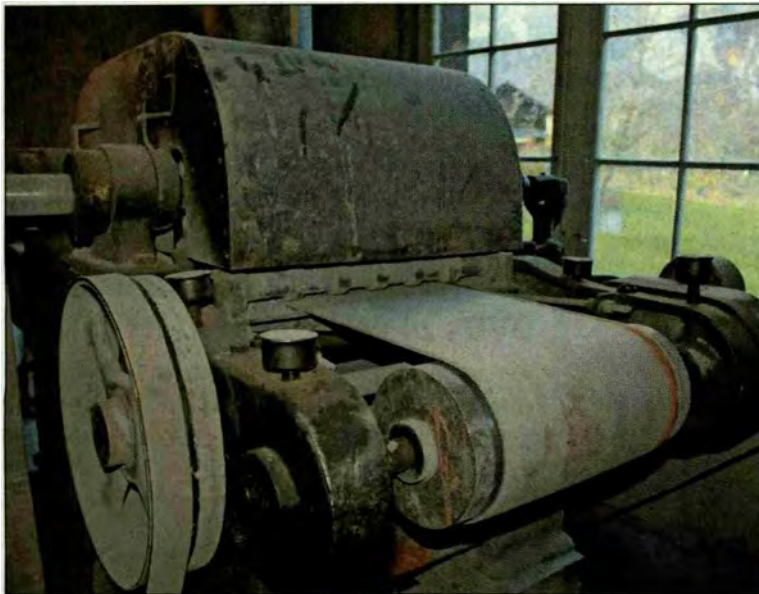
Diese Maschine poliert die Schiefertafeln glatt.
