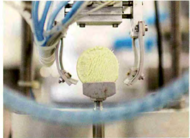
Modernste Produktionsanlagen fertigen bei der GESKA AG in Glarus heute stündlich bis zu 1'600 Zigerstöckli.
