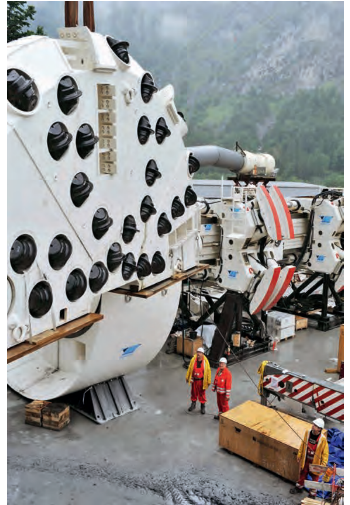
Fridolin Walcher, Tierfehd, Tunnelbohr- maschine, Bohrkopf- montage , Farbdruck auf Innova-Baumwoll- papier, 100 × 66 cm, 2010.
