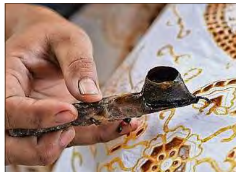
Der Canting, ein kleiner Behälter aus dünnem Kupferblech mit Abflussröhrchen für das Wachs.
