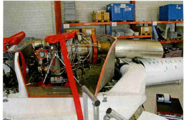
Die Honeywell-HTS900-2-Turbine wiegt läppische 160 kg, bringt aber 1000 PS Leistung.
