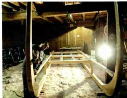
**Mega-Ausmasse.** Der Schlitten ist 6,4 Meter lang, 2,4 Meter breit und überragt den Erbauer **Fritz Dönni** um über einen Meter. Die Schlittenhöhe beträgt 2,8 Meter. Das Riesending wiegt 474 Kilogramm und die Kufen sind 12 Zentimeter breit. «Auf der Ladefläche haben 20 bis 30 Leute Platz», so der Erbauer.
