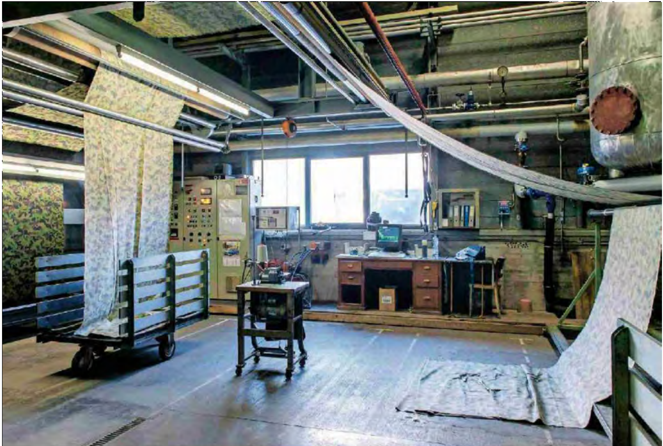
Die fertig bedruckten Stoffe laufen über ein Wasch- und Trocknungssystem.
