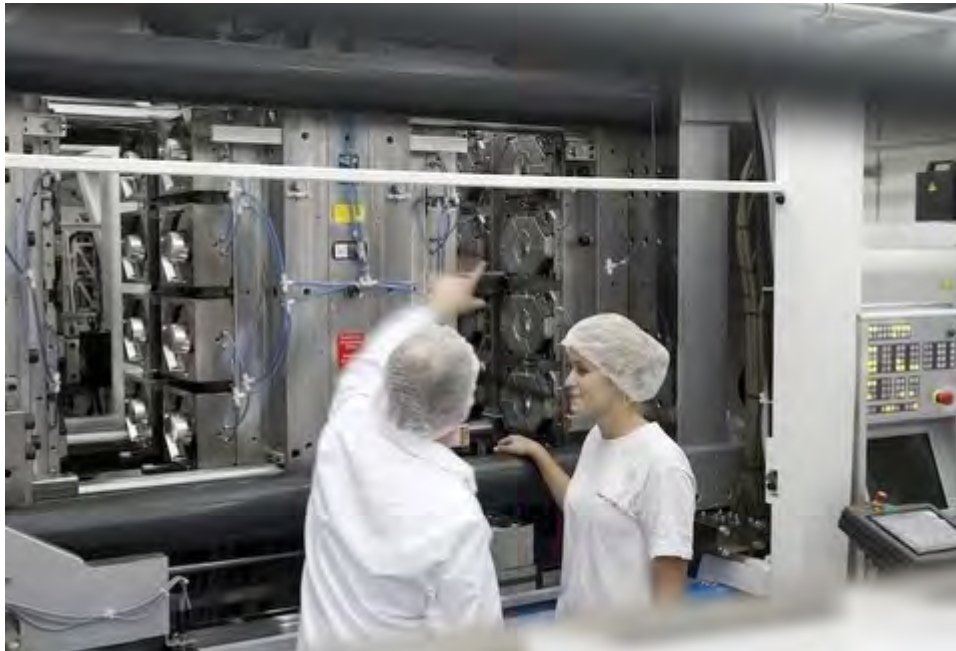
Ein Blick auf das 8+8-Etagenwerkzeug von Müller, das Knauer bei der Herstellung der neuen Exquisa-Becher eine hohe Produktionseffizienz garantiert
