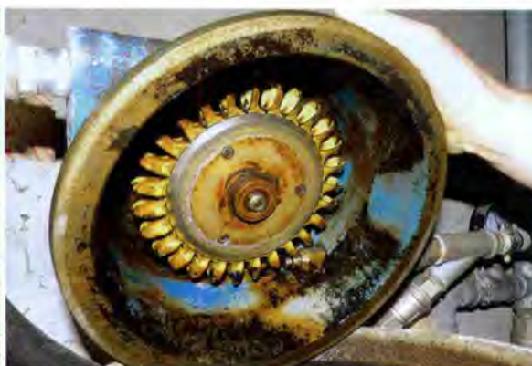
Peter Dürst zeigt die Peltonturbine (rechts) im Sennereigebäude. Der Betrieb ist weniger das Problem, als das Speichern der überschüssigen Energie.
