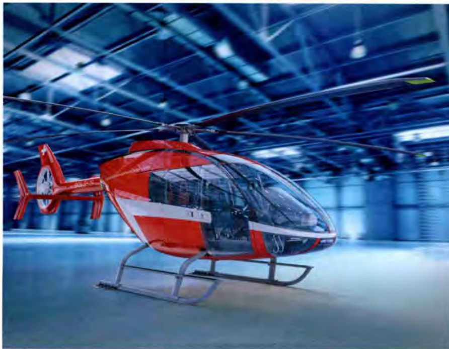
Der «SKYe SH09» verfügt als erster Helikopter über eine «Full-Carbon»-Struktur.
