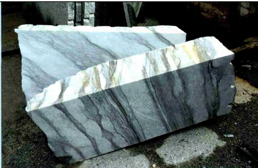
An diesen beiden zugefrästen Steinblöcken lassen sich Strukturen und Farben des Blausee-Kieselkalks aus Mitholz besonders gut ablesen.
