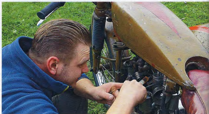
Schmiermaxe: Olaf Buschbeck ver- sorgt den offenen Ventiltrieb am Halb- liter-JAP-Motor
