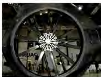
Der grosse, leistungsfähige Fenestron ist ebenfalls eine Eigenentwicklung
