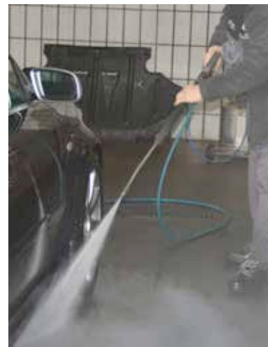
Die Reinigung mit einer Hochdrucklanze spart Wasser.
