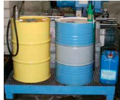
Auslaufende Flüssigkeiten müssen zurückgehalten werden: Auffangwannen beim Gebindelager.
