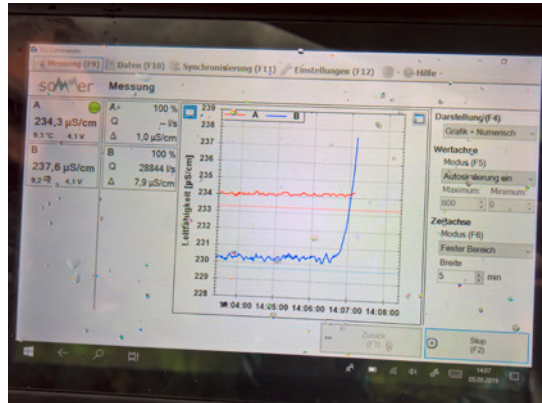
Mit einem Messgerät wird die Leitfähigkeit im Gewässer festgehalten (AUE).
