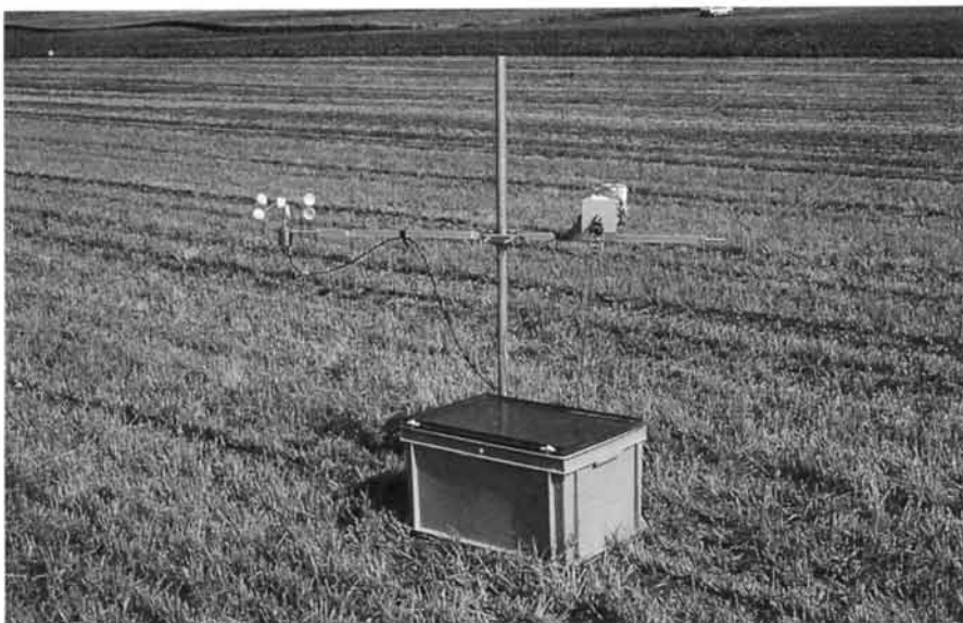
Abb. 3. Praxisnahe Feldversuche im Massstab 1:1: Kontinuierliche Messung der NH_3 -Konzentration und der Windgeschwindigkeit auf einer bestimmten Höhe über Boden während 2–4 Tagen.
